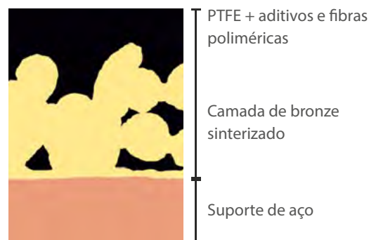
Fig. 2: Estrutura do DP4-B
