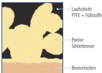
Laufschicht PTFE + Füllstoffe
