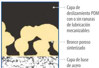
Capa de deslizamiento POM con o sin ranuras de lubricación mecanizables
