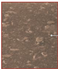
POM + Festschmierstoffe + Füllstoffe
