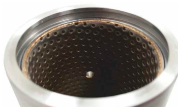
Innen ausgedrehte, montierte Buchse, um Innendurchmessertoleranz zu verkleinern
