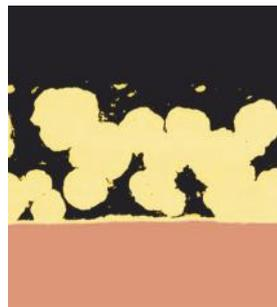
Abb: DU-B Mikroschliffbild
