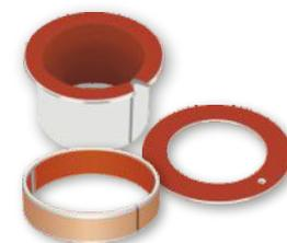
Les paliers DP4-B procurent les mêmes avantages que les paliers DP4®, tout en offrant également des propriétés antimagnétiques et de résistance à la corrosion grâce à leur support bronze. Ils délivrent d'excellentes performances en fonctionnement à sec, et plus particulièrement dans les applications avec un fonctionnement intermittent et des mouvements alternatifs ou oscillants.
